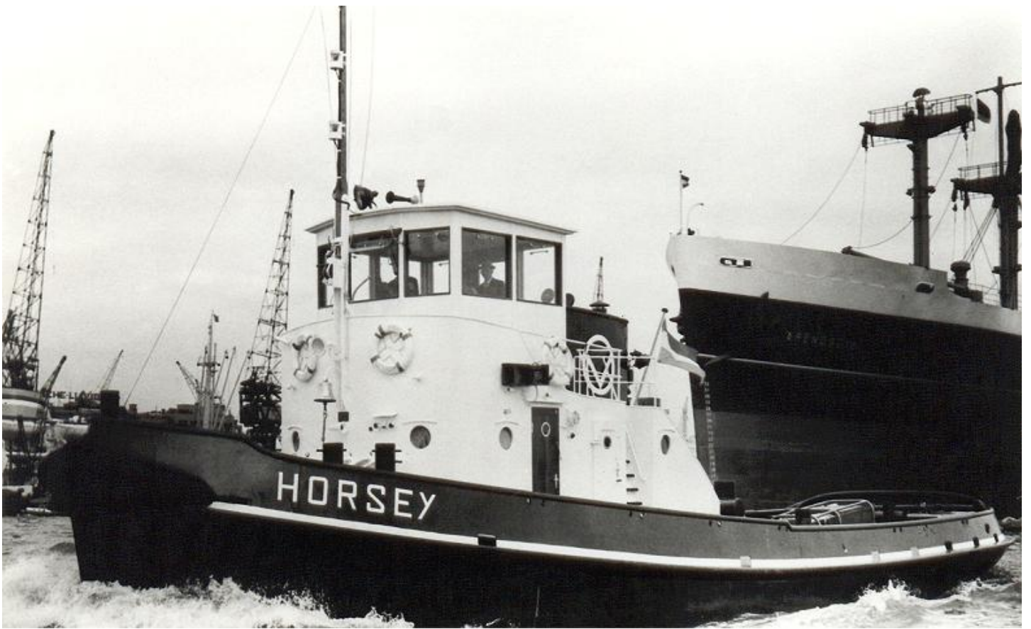
VO.slbt 14 m.s. HORSEY 2309677 1956-1984 motorsleepboot Gebouwd 1956, Hilgers A.G., Rheinbrohl (8085). 91,88 BRT, 0 NRT. 19,249 ton laadvermogen. 19,25 m 3 waterverplaatsing. 24,60 x 6,32 x 2,80 x 2,500 meter. Trekkracht 6 ton (1983). 500 EPK, 600 IPK, 2 x 6 cyl, 2 tew, 190 x 350, 430 omw/min., vertraagd naar 1 schroef, Bolnes 6L, N.V. Motorenfabriek "Bolnes", Bolnes (#1557 en #1558). (Foto's proefvaart en overdracht: archief Phs. van Ommeren).
