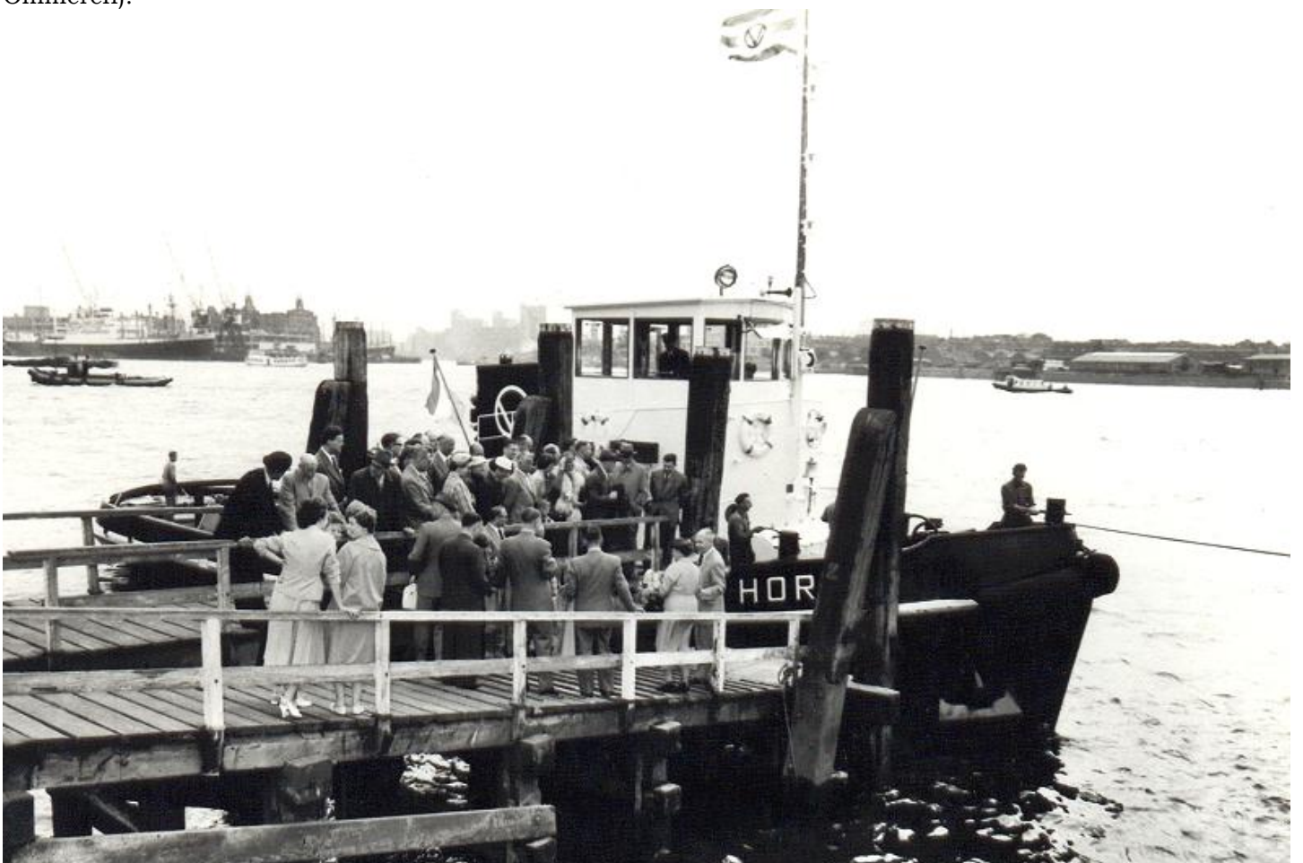
VO.slbt 14 m.s. HORSEY 2309677 1956-1984 motorsleepboot Gebouwd 1956, Hilgers A.G., Rheinbrohl (8085). 91,88 BRT, 0 NRT. 19,249 ton laadvermogen. 19,25 m 3 waterverplaatsing. 24,60 x 6,32 x 2,80 x 2,500 meter. Trekkracht 6 ton (1983). 500 EPK, 600 IPK, 2 x 6 cyl, 2 tew, 190 x 350, 430 omw/min., vertraagd naar 1 schroef, Bolnes 6L, N.V. Motorenfabriek "Bolnes", Bolnes (#1557 en #1558). (Foto's proefvaart en overdracht: archief Phs. van Ommeren).
